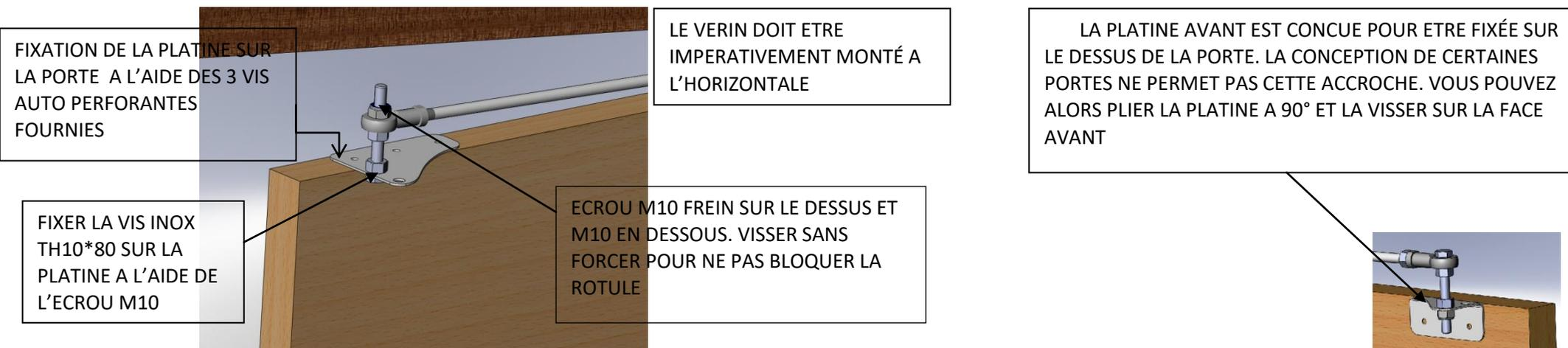
SUIVANT LE SENS D'OUVERTURE DE LA PORTE LA PLATINE ARRIERE SE FIXE EN DESSUS OU EN DESSOUS DU VERIN (figures 1 & 2).
